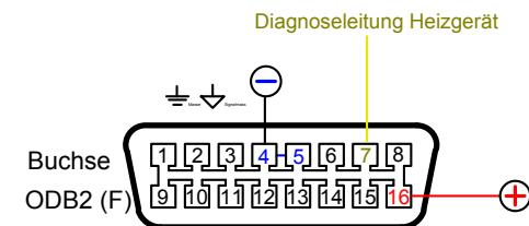
Abbildung zeigt Stecker von der Lötanschlussseite !!!
